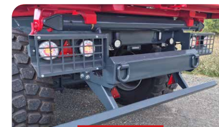
BARRE DE POUSSÉE ARRIÈRE ET BAE
