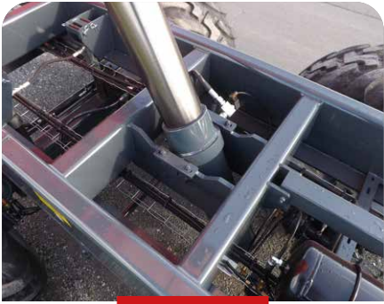
LARGEUR CHASSIS 1 160 MM
