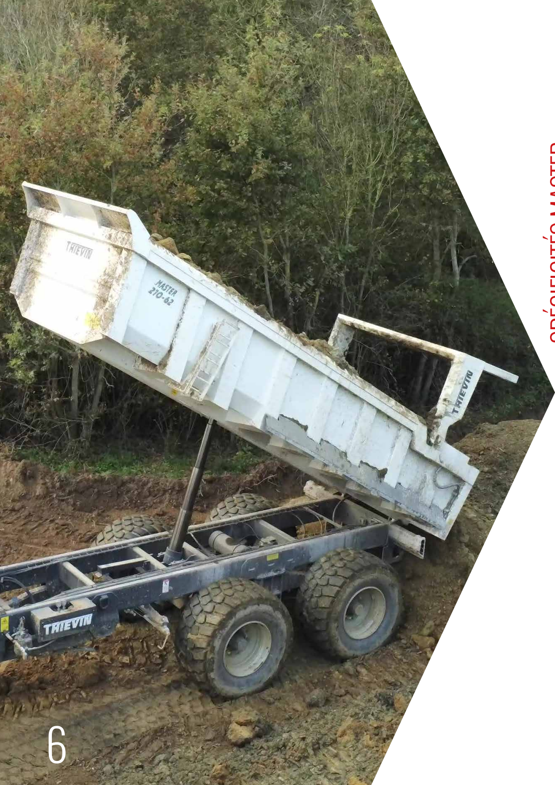
PORTE ARRIÈRE HYDRAULIQUE MONOBLOC TYPE LEADER (1DE)
