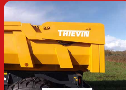
PORTE ARRIÈRE HYDRAULIQUE MONOBLOC TYPE LEADER (1DE)
