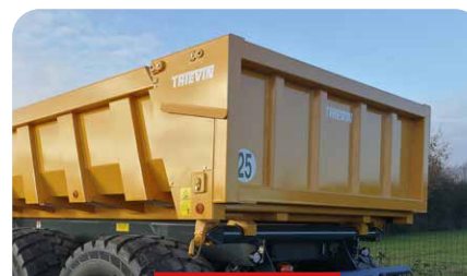
PORTE MONOBLOC ET BRAS DE PORTE INTÉGRÉ DANS LA CAISSE
