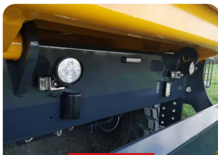
2 FEUX DE RECUIL À COMMANDE MANUELLE
