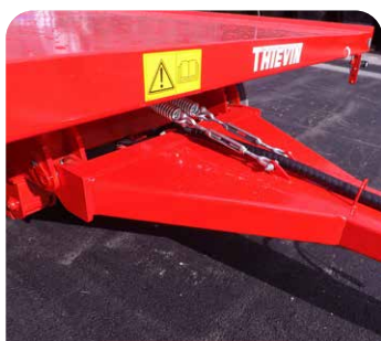
FLÈCHE SUSPENDUE PAR DEUX RESSORTS
