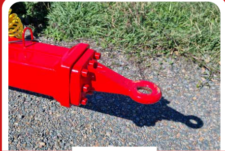
FLÈCHE ANNEAU BOULONNÉ SUR PL 260
