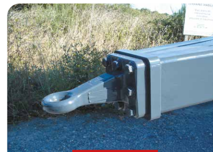
FLÈCHE AVEC ANNEAU DÉMONTABLE
