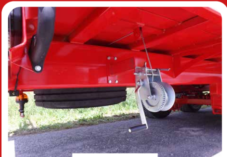
ROUE DE SECOURS AVEC FIXATION
