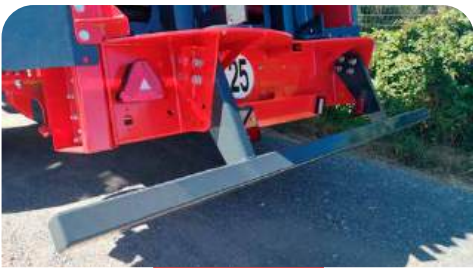
FEUX À LED BARRE ANTI ENCASTREMENT
