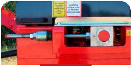
TENSION DE CHAÎNES PAR RONDELLES BELLEVILLE AVEC PALIERS BAGUÉS ET GRAISSÉS AVEC PALIERS
