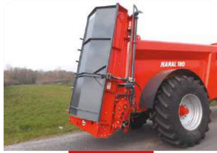
VOLET DE BORDURE HYDRAULIQUE SUR HÉRISSEMENTS VERTICAUX
