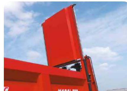
PORTE GUILLOTINE AVEC PLATS ANTI-BLOCCAGE SUR TUBES DE PORTE
