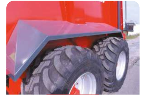
GARDE-BOUE SUR MARAL AVEC TANDEM À BIELLES
