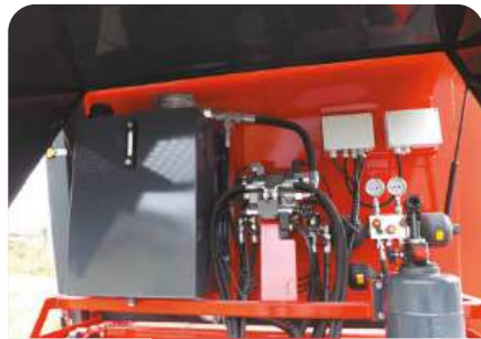
CENTRALE HYDRAULIQUE INDÉPENDANTE
