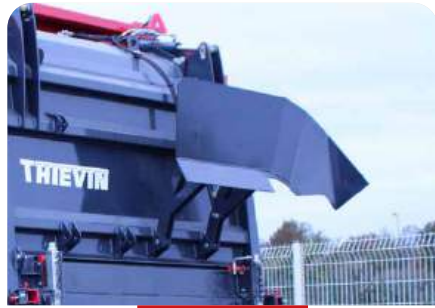
VOLET DE BORDURE HYDRAULIQUE SUR TABLE D'ÉPANDAGE
