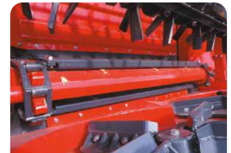
CHAÎNES PLATES AVEC BARETTES DÉMONTABLES
