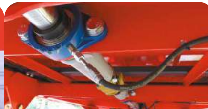
REGROUPEMENT POINT DE GRAISSAGE (OPTION)
