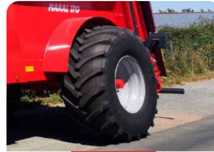
GARDE-BOUE SUR MARAL AVEC SIMPLE ESSIEU
