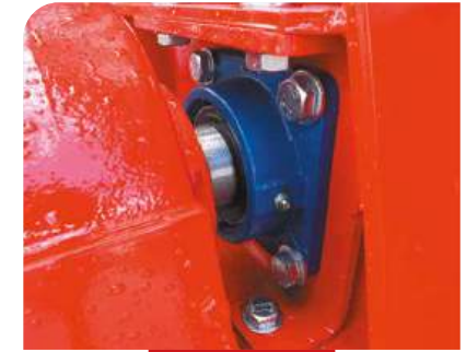
ARBRE D'ENTRAÎNEMENT MONTÉ SUR PALIERS Ø 60 MM
