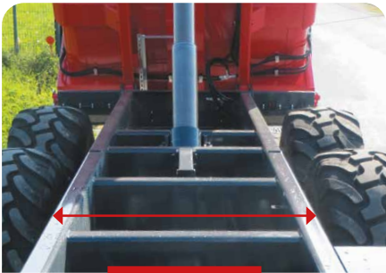
CHÂSSIS LARGE (1 600 MM) POUR UNE MEILLEURE STABILITÉ
