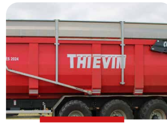
DOUBLE POTEAUX EXTÉRIEURS DE CAISSE (d'origine avec réhausses ensilage)
