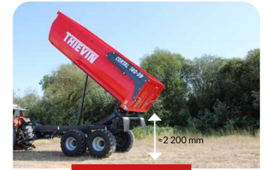
SEMI-ÉLÉVATRICE Dégagement \approx 2\,200 mm* avec roues d'origine
