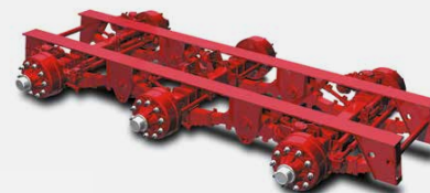
Tridem à bielles Suspension à lames version surbaissée Seulement en roues R22.5
