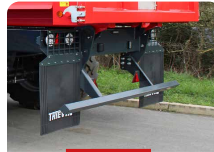
BAVETTES ARRIÈRE CAOUTCHOUC BARRE ANTI-ENCASTREMENT
