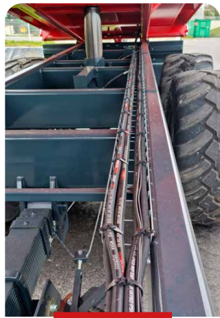
PASSAGE DES FLEXIBLES DANS CHEMIN DE CÂBLES
