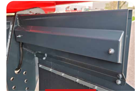
PROTECTION DES CONNECTIQUES DES FEUX LED
