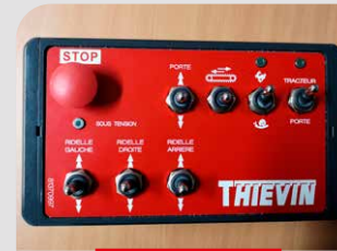
BOÎTIER DE COMMANDE À BOUTONS
