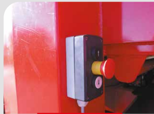
COMMANDE ÉLECTRIQUE DE TAPIS À L'ARRIÈRE POUR BENNAGE TRAPPE
