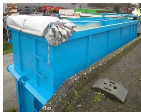
Cette gamme de bennes amovibles THIEVIN, est dotée d'une bâche manuelle coulissante sur 2 câbles, de l'arrière vers l'avant et ouvrant totalement le caisson.
